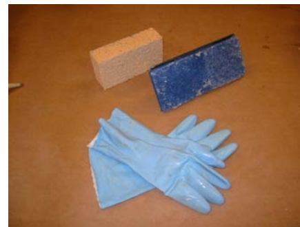
Epoksilietteen poistoon imukykyinen sieni kahden pesuastian taktiikalla
